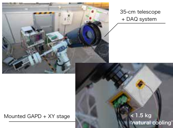
図 7: やまがた天文台の望遠鏡に取り付けた試作システム。治具の中で自動ステージによって 2 軸にセンサが動く。
