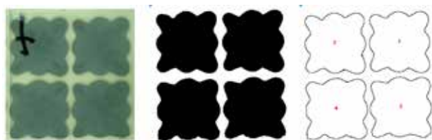
図 8: ImageJ を用いた画像解析。左が取得した画像データ、中央が輝度を基準に接着剤と背景を分離し白黒画像に変換したもの、右が得られた白黒画像から輪郭を抽出したもの。
