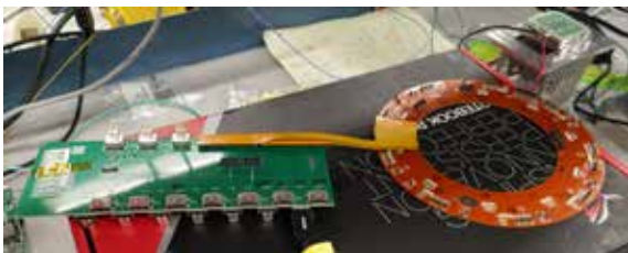
図 4: 測定中の様子. 中央の Ring の右上が Quad モジュール, 左側が PP0. PP0 の右下から伸びるのが DP ケーブルで後段の読み出しにつながる.
