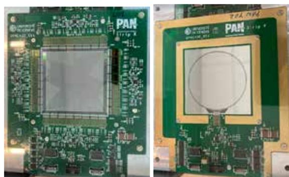
図 5: StripX (左) と StripY (右)。StripX は横方向, StripY は縦方向に沿ってストリップが並んでいる。有感領域は StripX が 51.2 mm  $\times$  51.2 mm, StripY は直径 51.2 mm の円形である。
