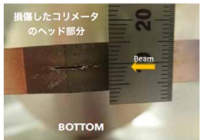
図 3: 実際に損傷したコリメータヘッドの様子。ビーム軸方向にスクラッチが見える。
