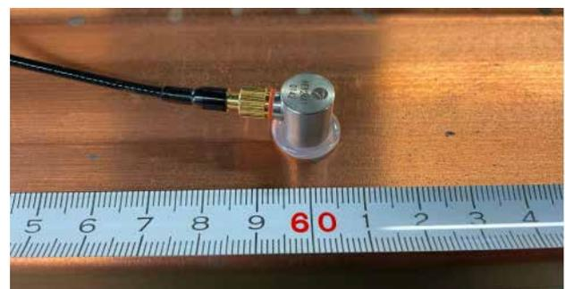
図 13: コリメータ周辺への設置を検討している音響センサー (AE124AT)。
