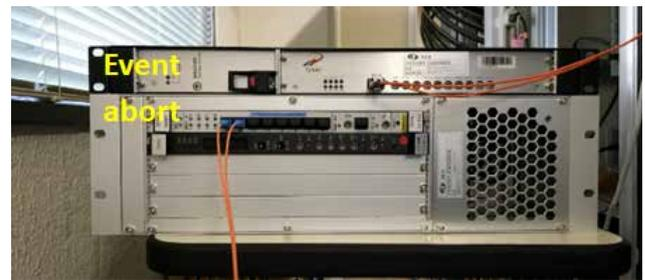
図11: 試験用アボートマスターモジュール及びアボートキッカー電磁石トリガー回路。VMEサブラック最上段スロットに挿入されているのがアボートマスターモジュール、その上にある1U高のモジュールがEvent Timing Systemモジュール。
