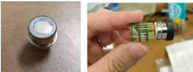
図 5: EMT(R15435-01)。実際設置する際にはアルミの箱に入れて遮蔽している。
