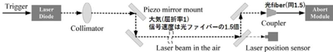
図 12: レーザーアポートシステムの概念図。
