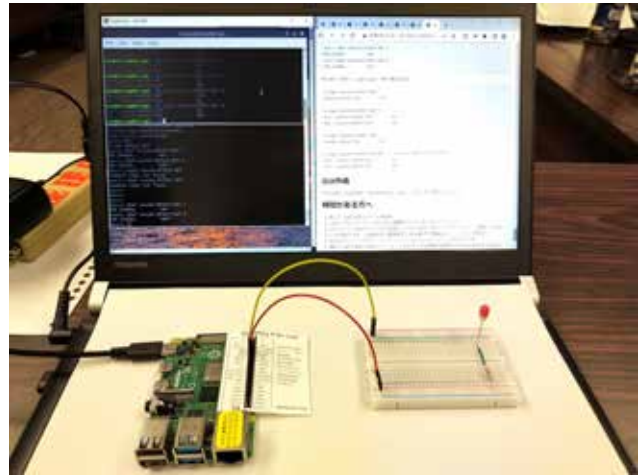
図2: Raspberry PiとLEDが取り付けられたブレッドボード
