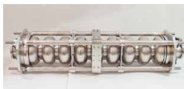
図2: 9セル TESLA 空洞 (写真: KEK)
