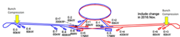
図 3: ILC 加速器でのビームダンプ配置 [7]。青が電子、赤が陽電子で、四角が可能なビームダンプ位置を表す。
