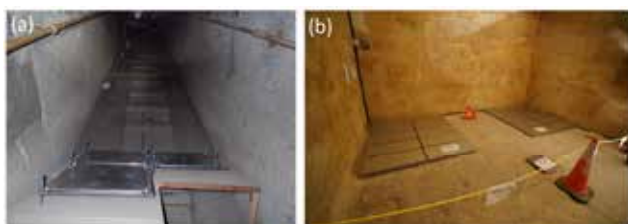
図10. クフ王のピラミッド内に設置した原子核乾板検出器。(a) 下降通路に設置したアルミ板型の検出器, (b) 女王の間に設置したアルミハニカム板型の検出器。
