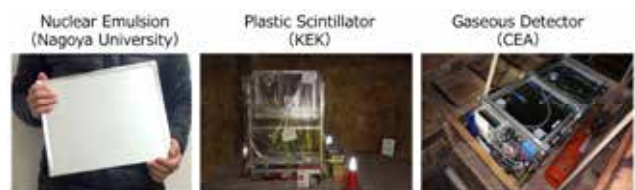
図4. ScanPyramidsで用いる検出器。
