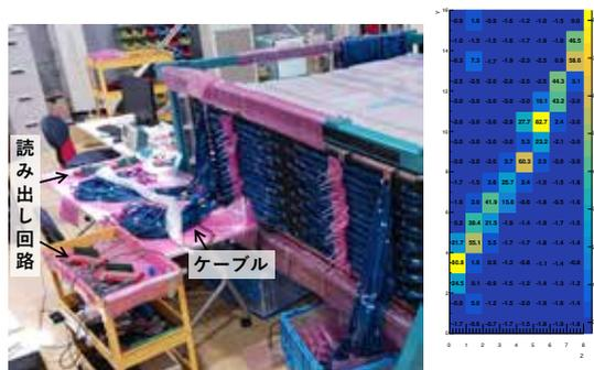
図8: 組み立て完了前の最終試験(左)とSuperFGDの初宇宙線候補事象(右)。側面の8×16チャンネル領域のみの読み出し。
