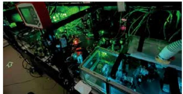
図 6: 244 nm パルスレーザー駆動中のレーザーーム。画像中央付近で橙色に光っているのがパルス増幅部の Ti:S 結晶。右側でフレームに覆われ水色に光っているあたりが第四高調波発生部である。
