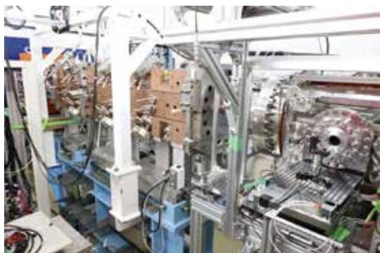
図 4: S2 エリア内の写真。右側に見えるのがミュオン冷却チェンバー, 左側にあるのが RFQ である。
