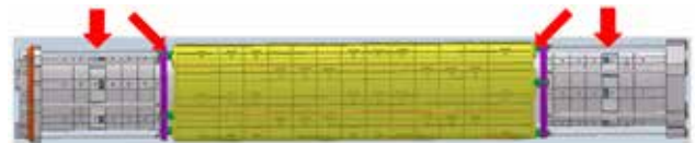
図 2: ALPHA-3 トラップのデザイン。中央が反水素生成のためのトラップ、その両端が陽電子冷却のためのトラップ。細矢印で示した箇所に反水素原子の蛍光を測定するための SiPM が、太矢印で示した箇所に Be イオンの蛍光を測定するための SiPM が設置される。
