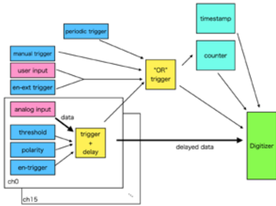
図 2: SLArpaas ファームウェアの概略図。いくつかの要素は見やすさのために省略している。2本の太い矢印は入力データの流れを表している。
