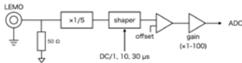
図 3: LEMO 入力から ADC までのブロック図。Shaper として DC coupling または 1, 10, 30 \mu s の shaping time が選択できる。
