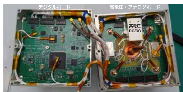
図 5: 最終組み上げ中のデジタルボード (DAQ) と高電圧・アナログボード (FEC)。
