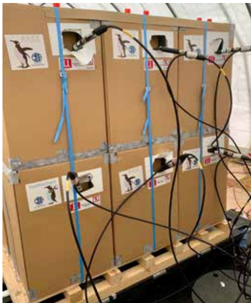
図 11: 南極点に到着したモジュールは、輸送・移動効率を考慮し、パレットに積載された状態のままで SPAT が実施される。これにより、空港、SPAT 施設、保管庫、掘削現場間での輸送が容易になる。
