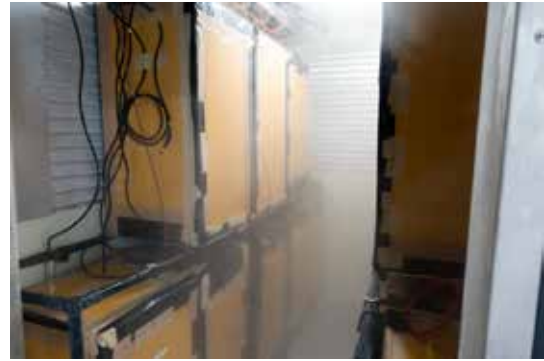
図 7: D-Egg を最大 16 台収容可能な最終受入試験用冷凍庫。試験時の温度は -40^{\circ}\text{C} 。黒色のケーブルは光ファイバー、赤色のケーブルは通信のためのケーブル。
